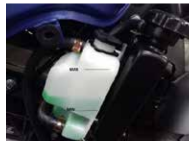
Zbiornik wyrównawczy płynu chłodzącego
