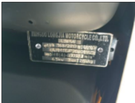
Tabliczka znamionowa jest przymontowana na ramie w tylnej części poniżej prawej obudowy.
