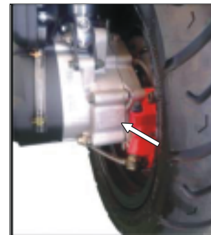
Numer silnika znajduje się na tylnej części karтеру silnika
