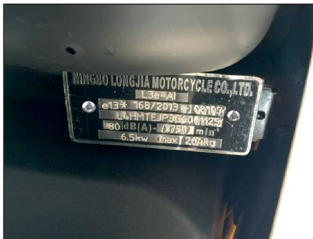
Tabliczka znamionowa jest przy- nitowana na ramie w tylnej części poniżej prawej obudowy.
